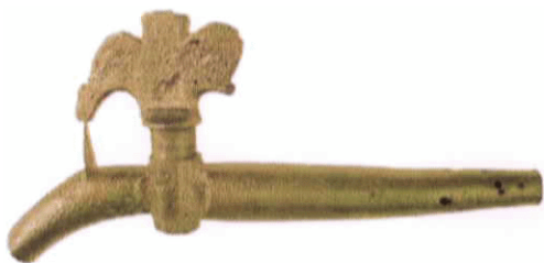
Cannelle ou chantepleur de tonneau en laiton (Régime français)
