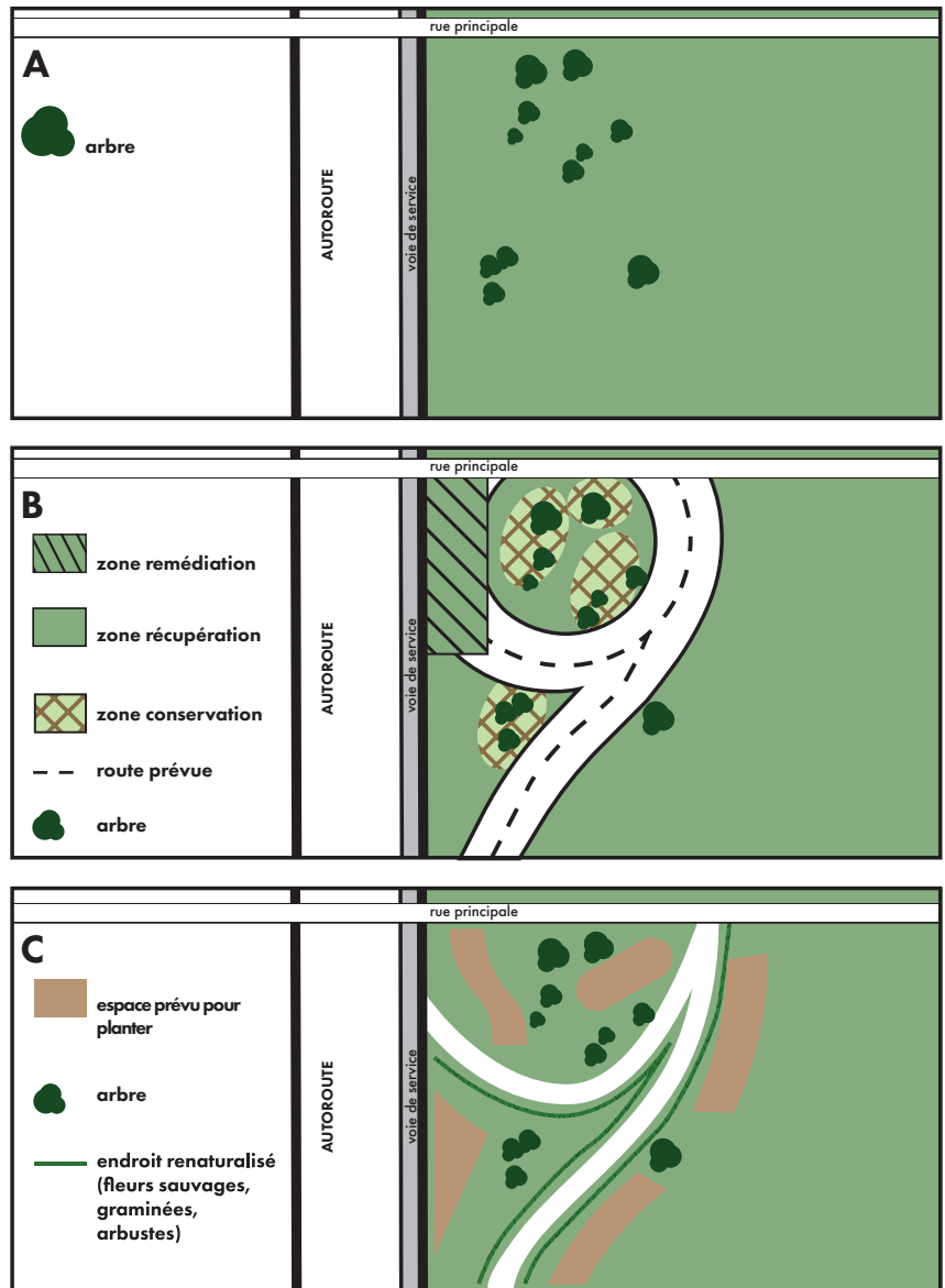
Fig. 7 Exemple d'interventions de conservation et de remise en état dans le cadre de la construction d'un échangeur : A) Situation initiale, B) Interventions de remise en état, C) Résultat final
