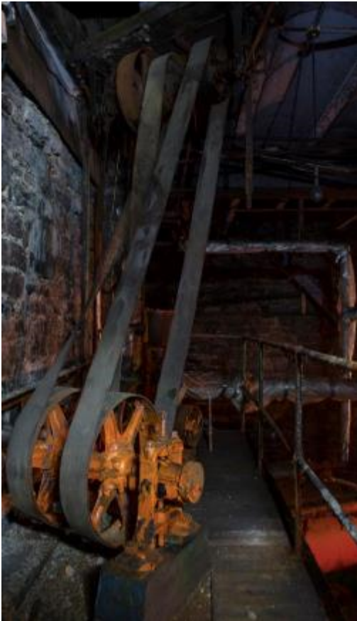
À gauche : équipements de contrôle de l'écluse encore présents au sous-sol.
