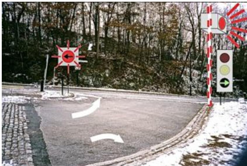
Signalisation à la jonction du sortie du terrain du stationnement du belvédère, pendant la phase **est**. Barrière ouverte. Feu rouge clignotant avec flèche pour les sorties à la gauche, feu rouge clignotant pour la montée vers l'ouest par Camillien Houde, et flèche verte pour les sorties à la droite. Les flèches blanches sont à peinturé sur l'asphalte.
