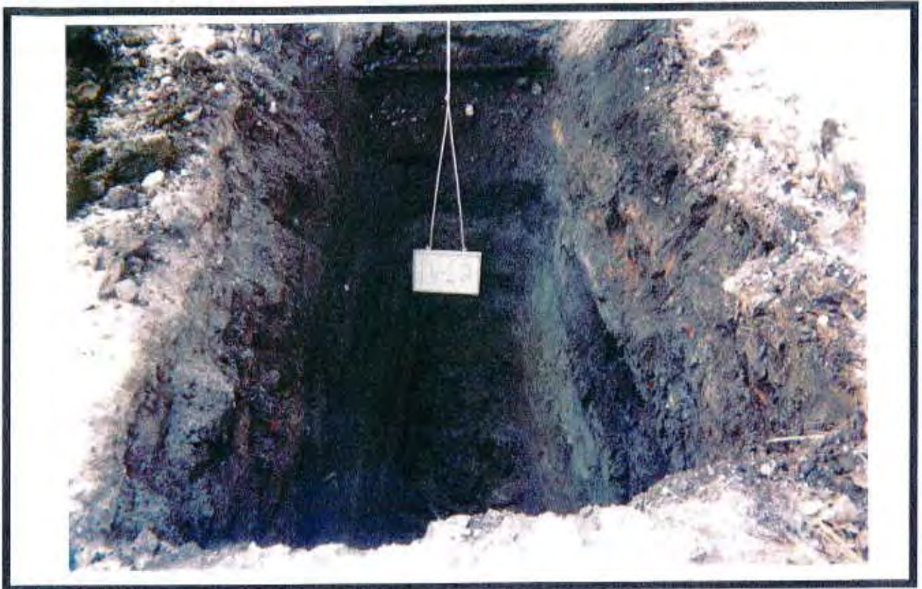
Planche # 8 : Vue du puits d'exploration PU-12. On note la couche de remblais et de déchets sur le premier mètre.
