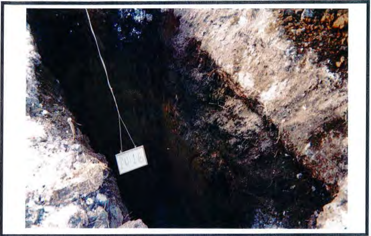
Planche # 10 : Vue du puits d'exploration PU-16. On observe les couches de remblais et de matières organiques présentes. Le sol naturel est visible en profondeur.
