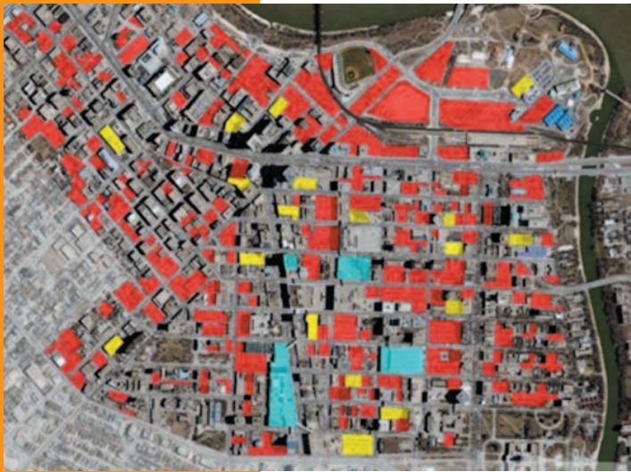
LE CENTRE-VILLE DE WINNIPEG - en rouge les stationnements de surface, en jaune les stationnements étagés, en bleu les stationnements souterrains Source : Brent Bellamy
