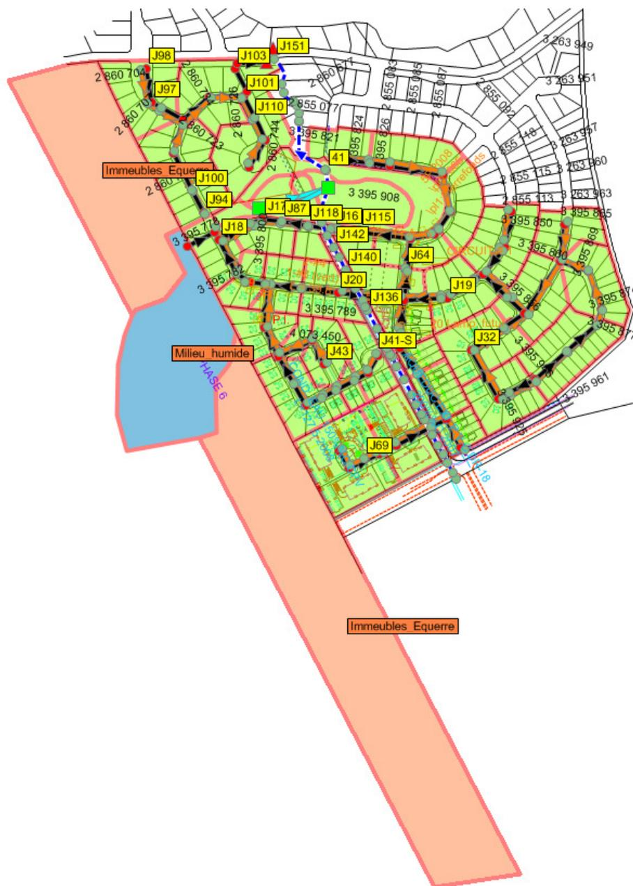
Figure 12 : Bassins et réseau de drainage du secteur Héritage-sur-le-Lac avec raccordement des Immeubles l'Équerre.
