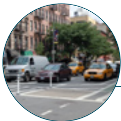
MARQUAGE AU SOL POUR INTERDIRE LE STATIONNEMENT À MOINS DE 5 MÈTRES D'UNE INTERSECTION.
