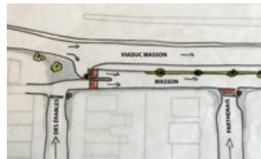
Avancée de trottoir prononcée pour limiter l'accès des véhicules aux rues locales et sécuriser le passage des piétons vers le viaduc. Proposition issue de l'atelier de travail professionnel « L'aménagement sécuritaire des zones frontière » tenu à l'automne 2010.
