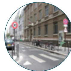
PORTE D'ENTRÉE DE QUARTIER : AVANCÉES DE TROTTOIR ET PASSAGE POUR PIÉTONS SÉCURISÉ.
