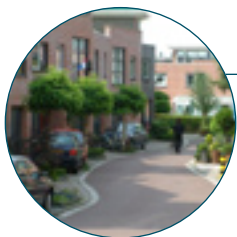
DÉVIATION DE LA CHAUSSEE À L'ENTRÉE D'UNE RUE LOCALE.
