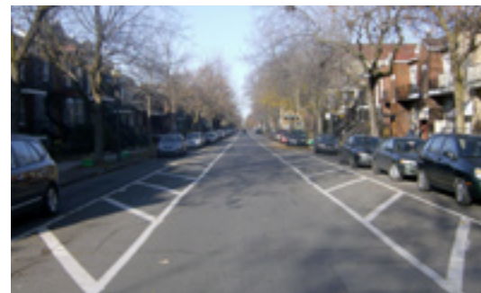
Réduction des voies de circulation par du marquage, première étape vers des modifications permanentes. 1 re Avenue, Montréal.
