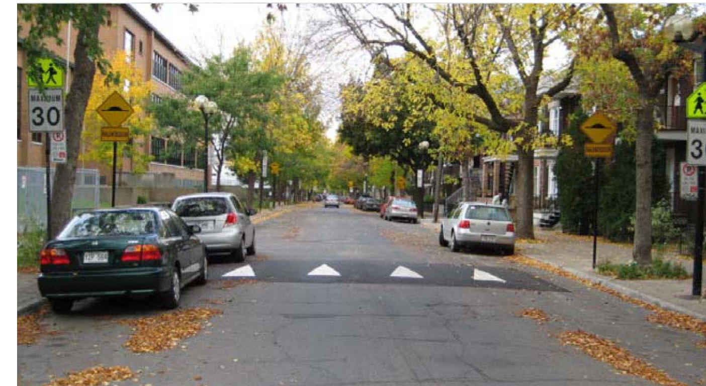
Dos d'âne et signalisation dans une zone scolaire
