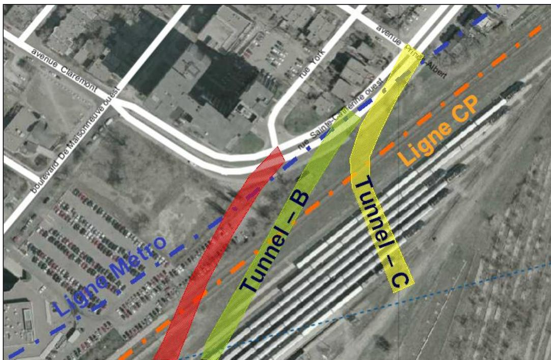
Figure 5.2 : Tracé des tunnels envisageables
