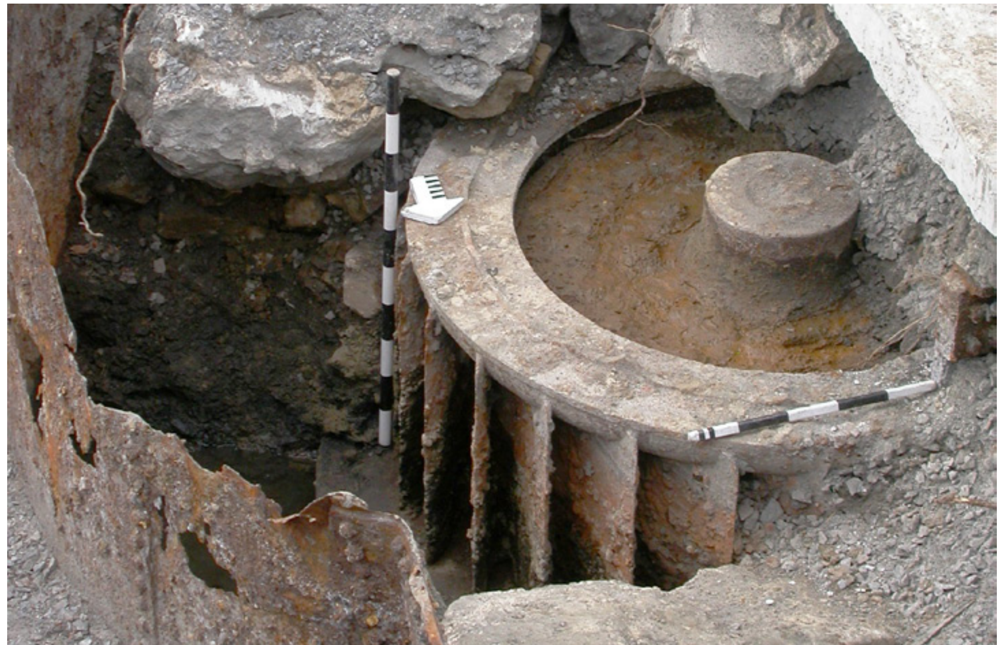
Turbine et caisson métallique de la Caledonian Iron Works Co., Pointe-des-Seigneurs Photo : SACL inc., 2009
