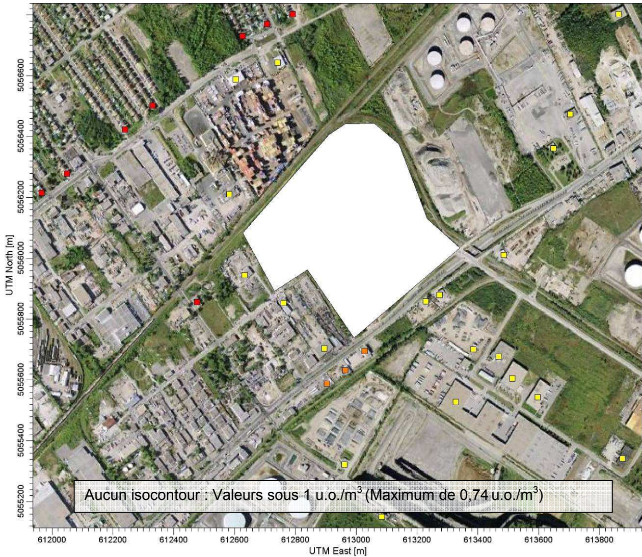
Figure F - 26 : Concentrations d'odeurs maximales au percentile 98 sur à proximité des infrastructures pour des récepteurs à 8 m – SE-2
