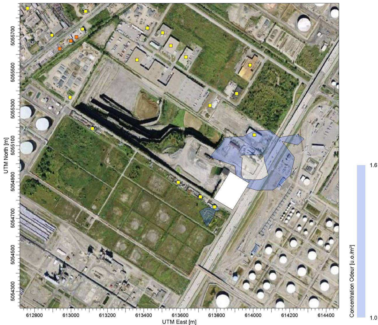
Figure F - 19 : Concentrations d'odeurs maximales au percentile 99,5 sur à proximité des infrastructures pour des récepteurs à 8 m – SE-1
