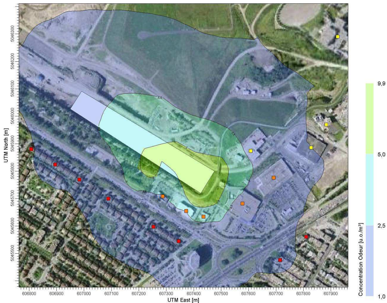
Figure F - 2 : Zoom autour des limites de propriétés des concentrations d'odeurs maximales au percentile 99,5 pour toutes les sources – SN-1
