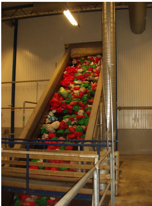
Photo 4 Tri manuel (types de déchets par couleur) et tri optique des déchets - Trollhättan
