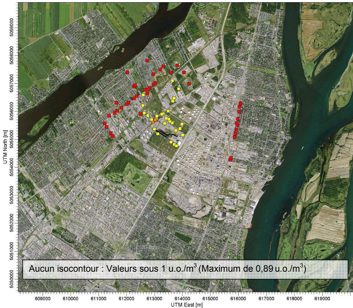
Figure F - 17 : Concentrations d'odeurs maximales au percentile 98 sur la zone d'étude pour toutes les sources – SE-1
