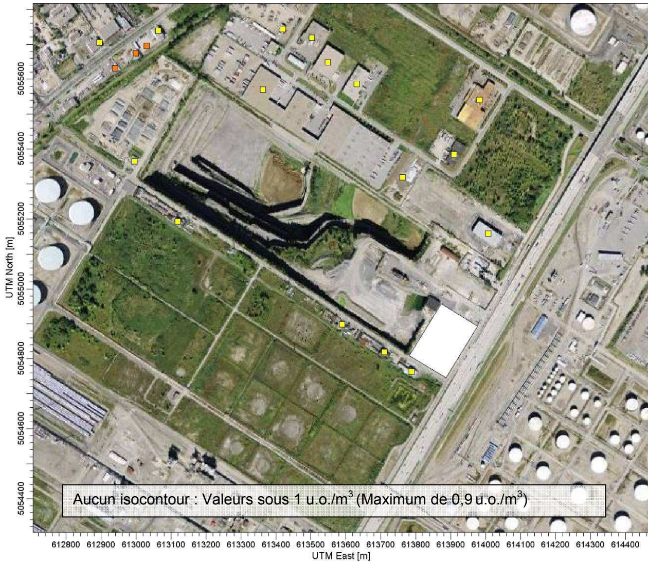
Figure F - 20 : Concentrations d'odeurs maximales au percentile 98 sur à proximité des infrastructures pour des récepteurs à 8 m – SE-1
