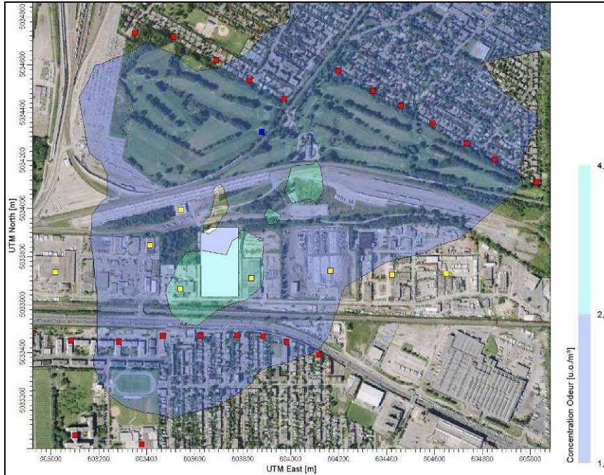
Figure E - 11 : Concentrations d'odeurs maximales au percentile 99,5 autour des limites de propriétés pour toutes les sources – SO-3
