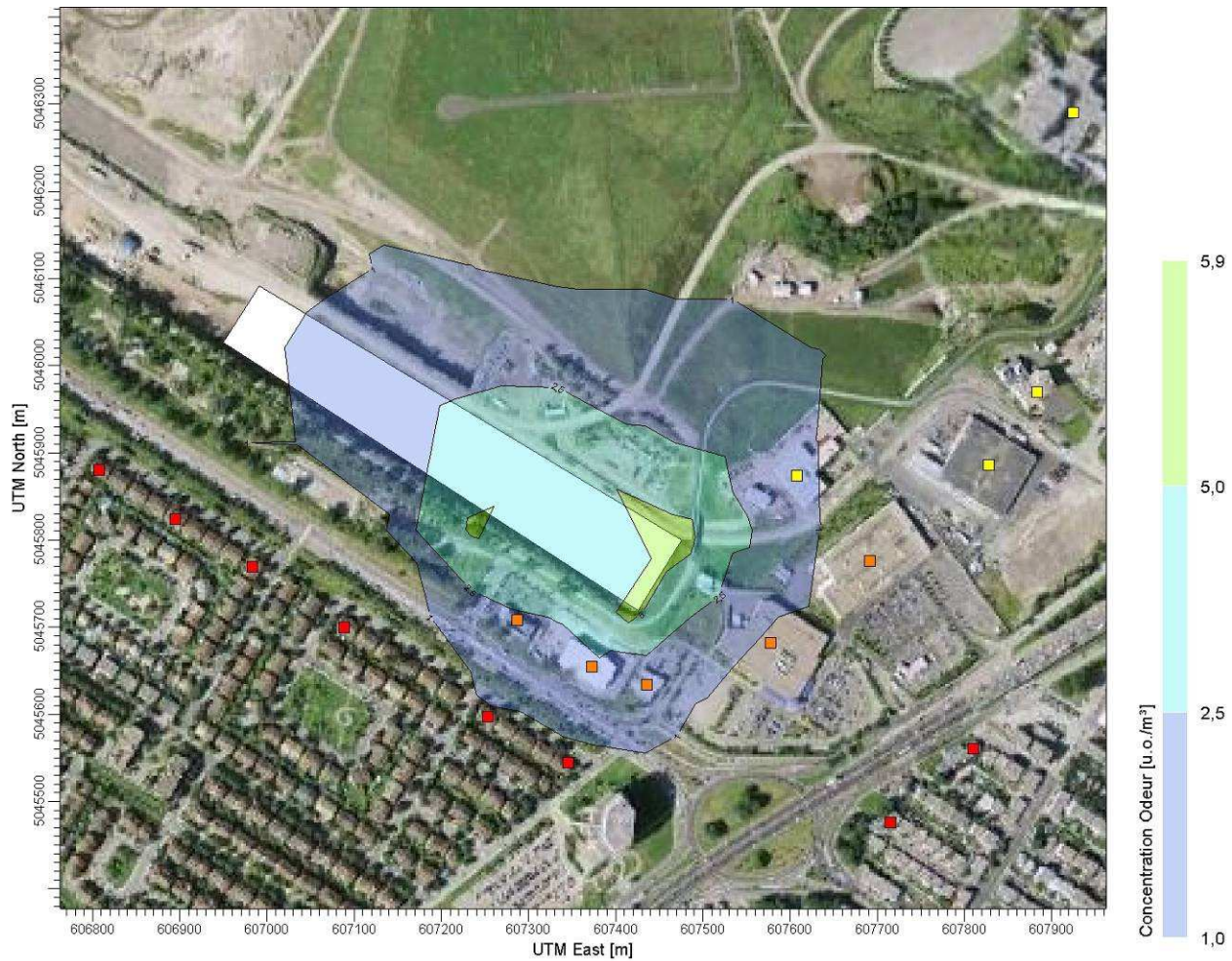
Figure F - 4 : Zoom autour des limites de propriétés des concentrations d'odeurs maximales au percentile 98 pour toutes les sources – SN-1
