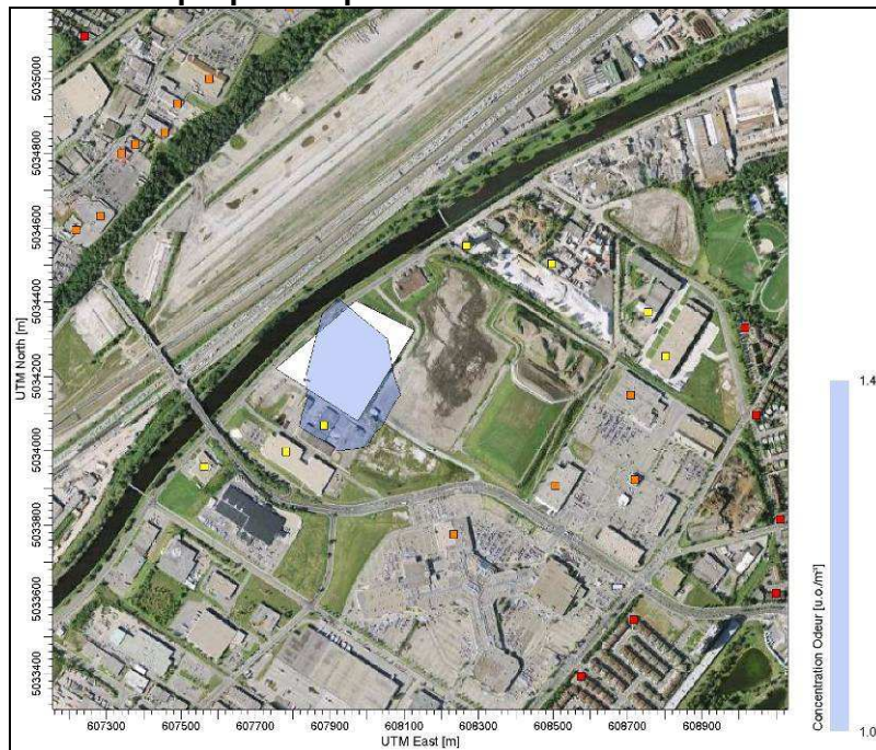
Figure E - 14 : Concentrations d'odeurs maximales au percentile 98 autour des limites de propriétés pour toutes les sources – SS-1
