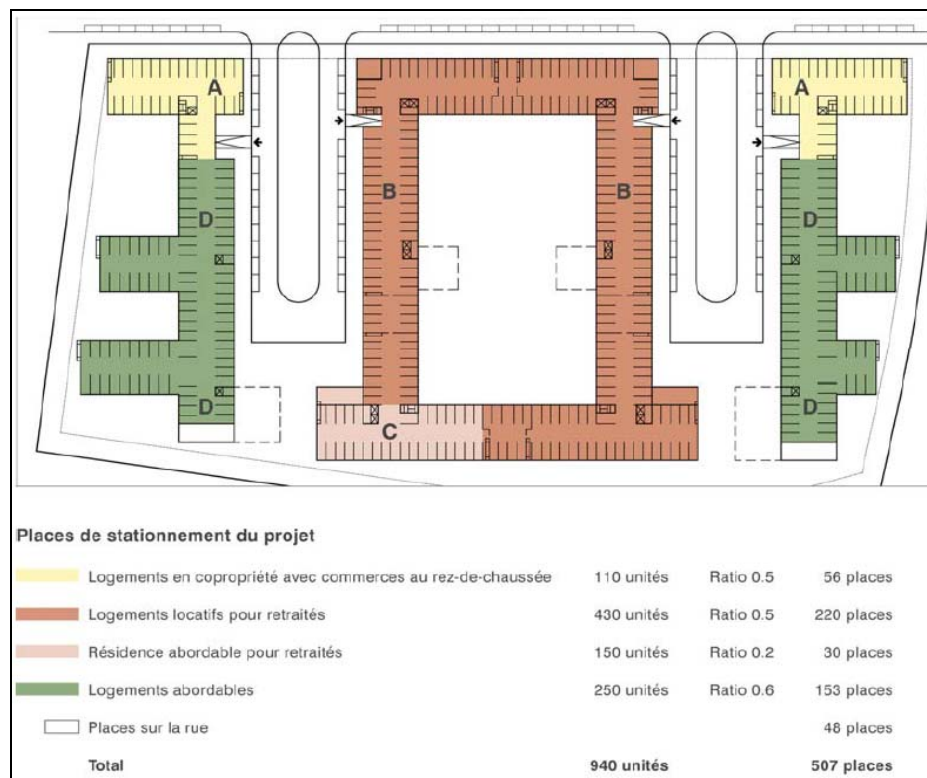
FIGURE 4.1 : AMÉNAGEMENT DU STATIONNEMENT
