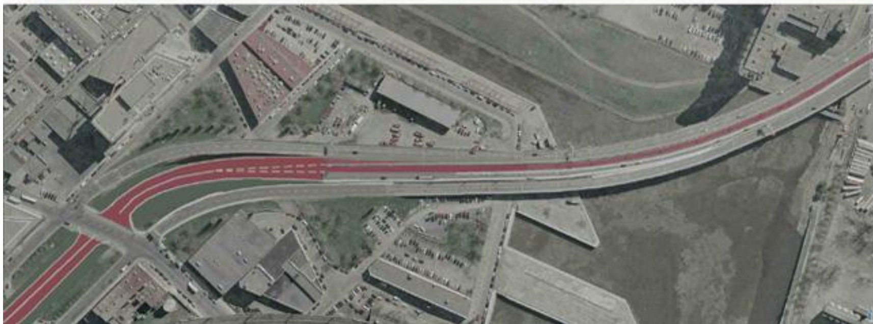
Étape-4: Construction de la rampe temporaire pour autobus sur remblai de Wellington.
