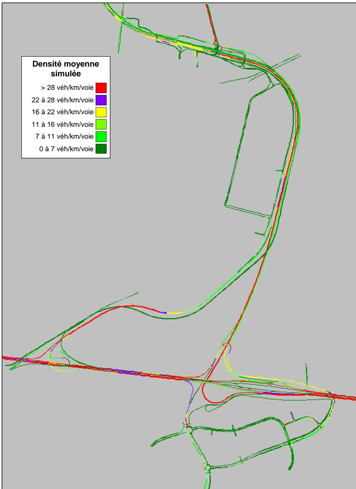
FIGURE 2.17 : SITUATION ACTUELLE - HPPM - DENSITÉS MOYENNES MESURÉES SUR VISSIM
