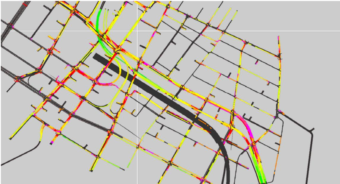
Figure 26 - Scénario préférentiel AM - Vitesses pratiquées lors des conditions de circulation les plus critiques, soit entre 8H30 et 8H45
