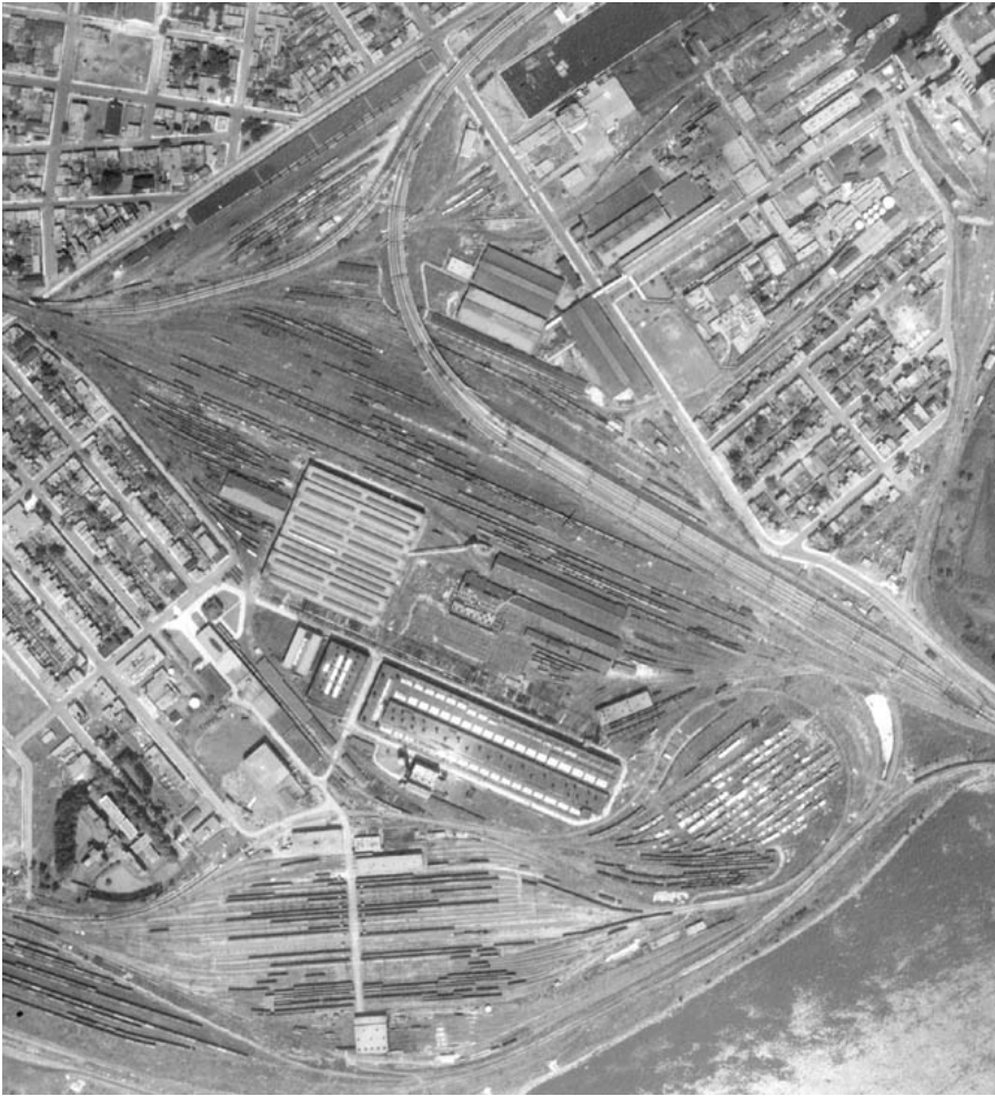
1950 – Extrait d'une photographie aérienne où l'on aperçoit, au bas, le remblai effectué dans le fleuve et l'ajout d'une cour de triage. Les voies ferrées menant au pont Victoria et traversant le site parallèlement à la rue Wellington ont été considérablement modifiées. Aussi, plusieurs des bâtiments qui figuraient sur la photographie de 1929 ont été démolis et remplacés par de nouvelles constructions. Source : Photothèque nationale de l'air, rouleau A12584, photo 45, échelle 1:10 000.
