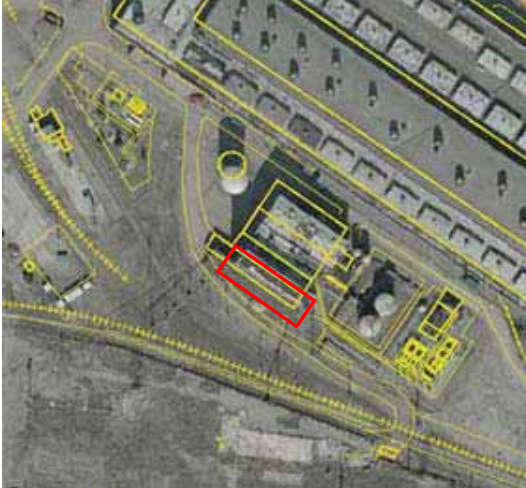
2002 – Un agrandissement sur le côté sud de la centrale thermique est visible sur cette orthophoto, mais ne figurait pas sur le plan urbain de 1990. La date exacte de cet ajout est imprécise. Source : Navigateur urbain, Ville de Montréal (modifiée par les auteurs).
