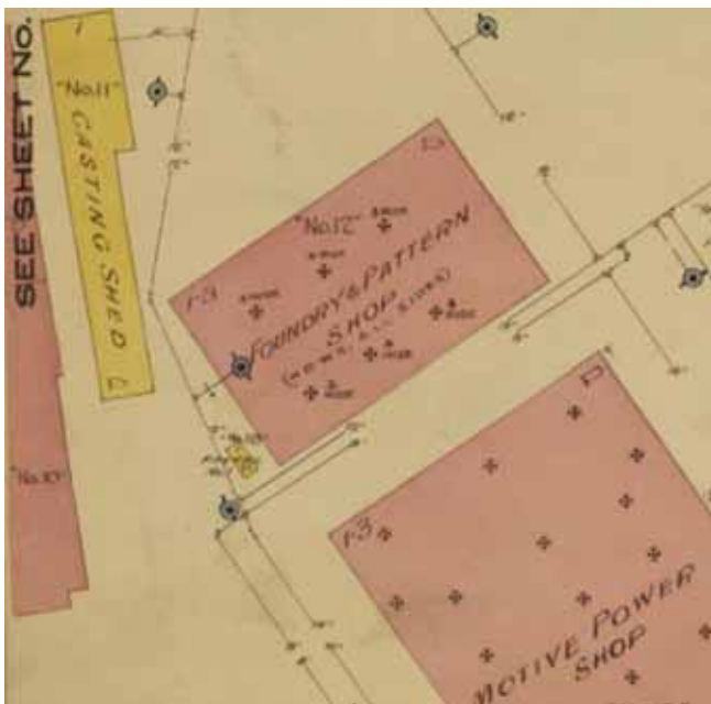
1938 – Cet extrait de plan d'assurance incendie nous informe que le bâtiment de forme rectangulaire abritant la fonderie et l'atelier des patrons (« Foundry and Pattern Shop ») est percé de fenêtres sur tous ses côtés. Sa coloration rose indique qu'il s'agit d'une construction de brique. Source : BANQ, extrait du plan du Underwriters' Survey Bureau, Insurance plan of the city of Montreal , vol 1, planche 46, 1918 révisé en 1938.
