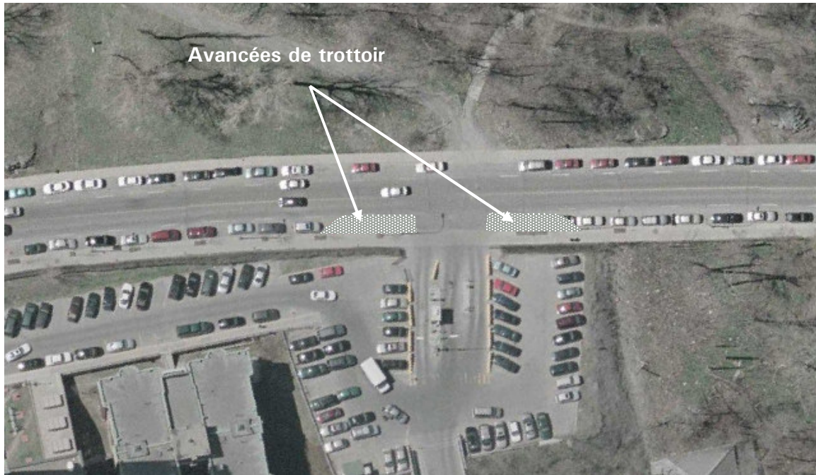
Figure 13 : Aménagement d'avancées de trottoir à l'accès de l'avenue Cedar
