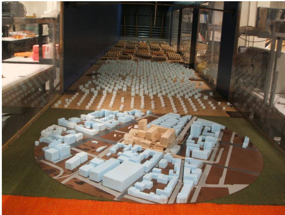
a) Maquette du développement Viger et des environs dans la soufflerie par vent du nord.
