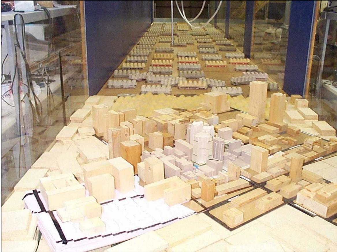
Figure A1 – La soufflerie à couche limite de l'Université Concordia.
