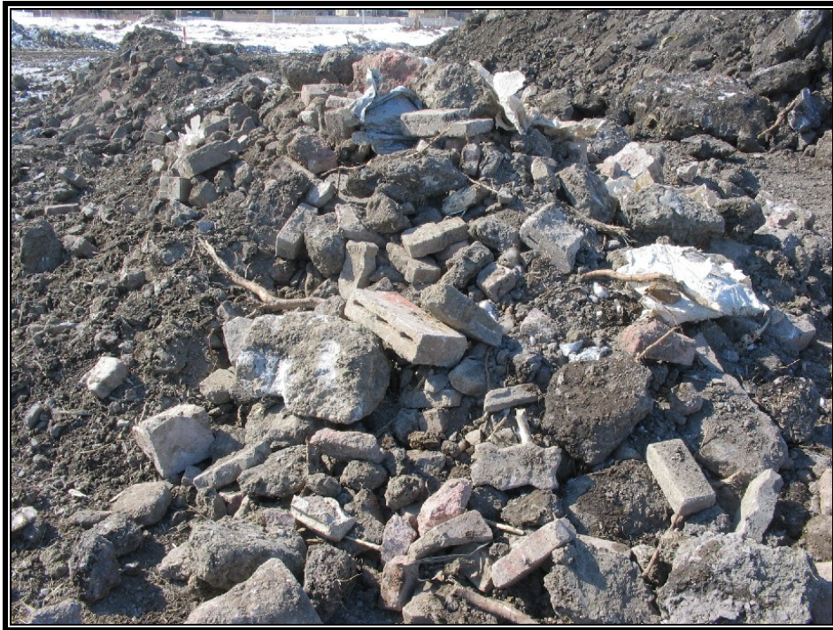
Photo 3 : Mélange de brique, pavé uni et blocs de béton.
