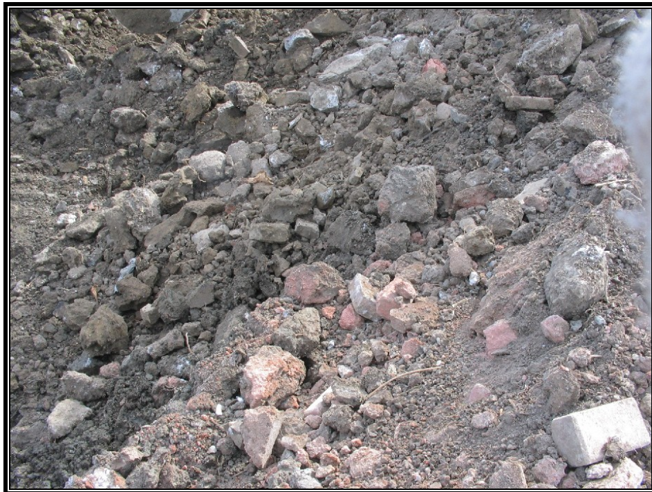
Photo 2 : Pavés unis et brique de construction dans le remblai.
