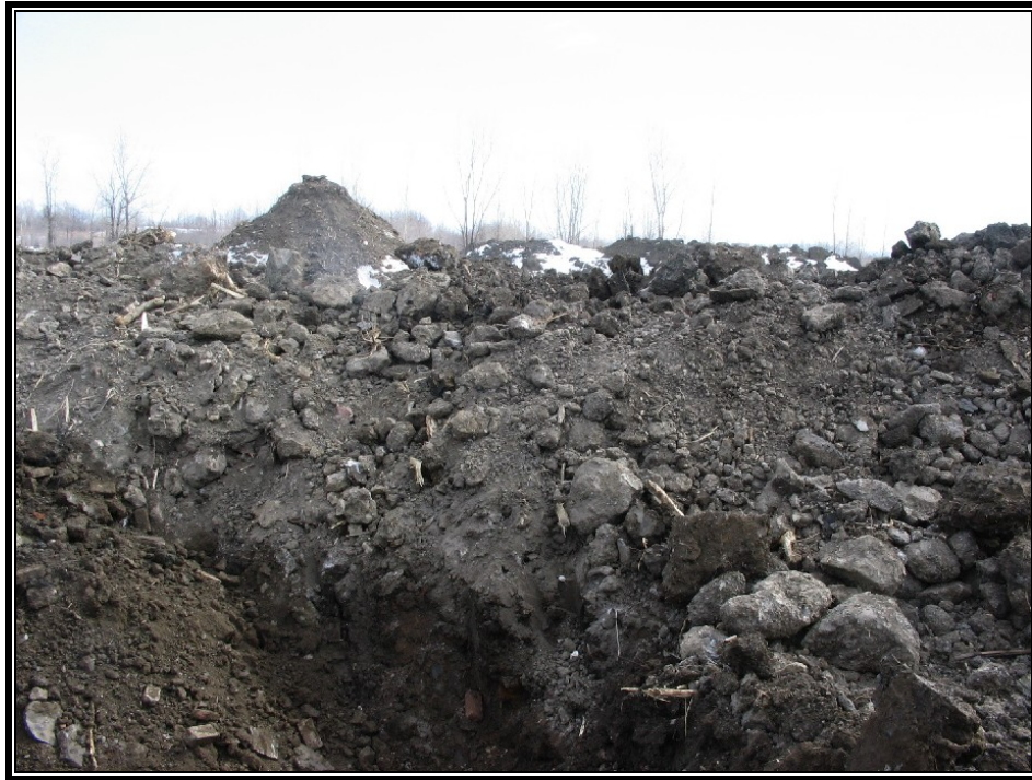
Photo 1 : Blocs de roc mêlés aux sols de remblai secteur sud-ouest.
