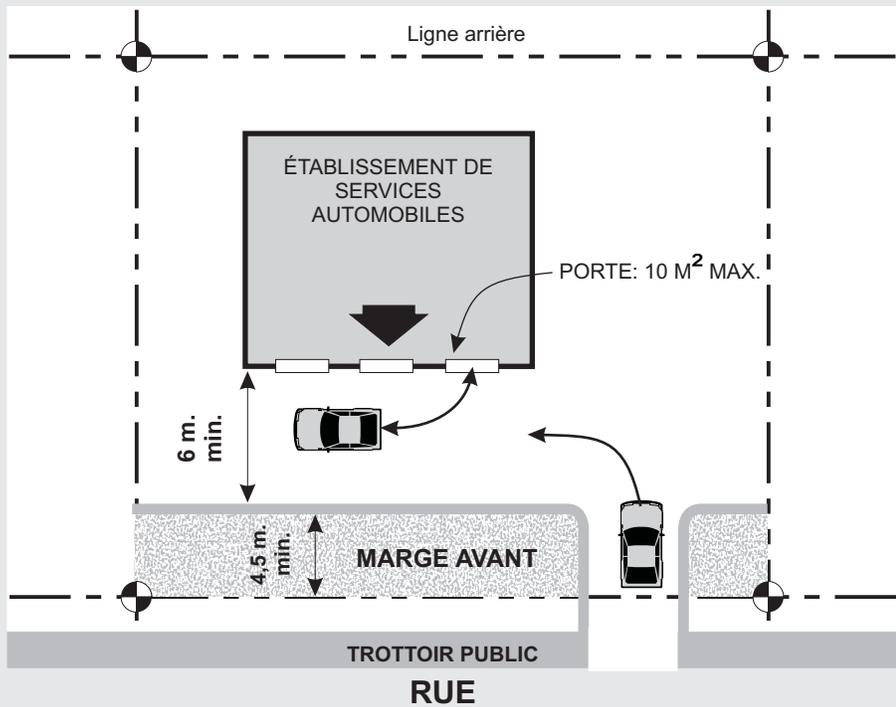
L'ESPACE DE MANOEUVRE DOIT PERMETTRE À UNE AUTOMOBILE D'Y ACCÉDER EN MARCHÉ AVANT, DE CHANGER DE DIRECTION ET DE SORTIR DU TERRAIN EN MARCHÉ AVANT.
