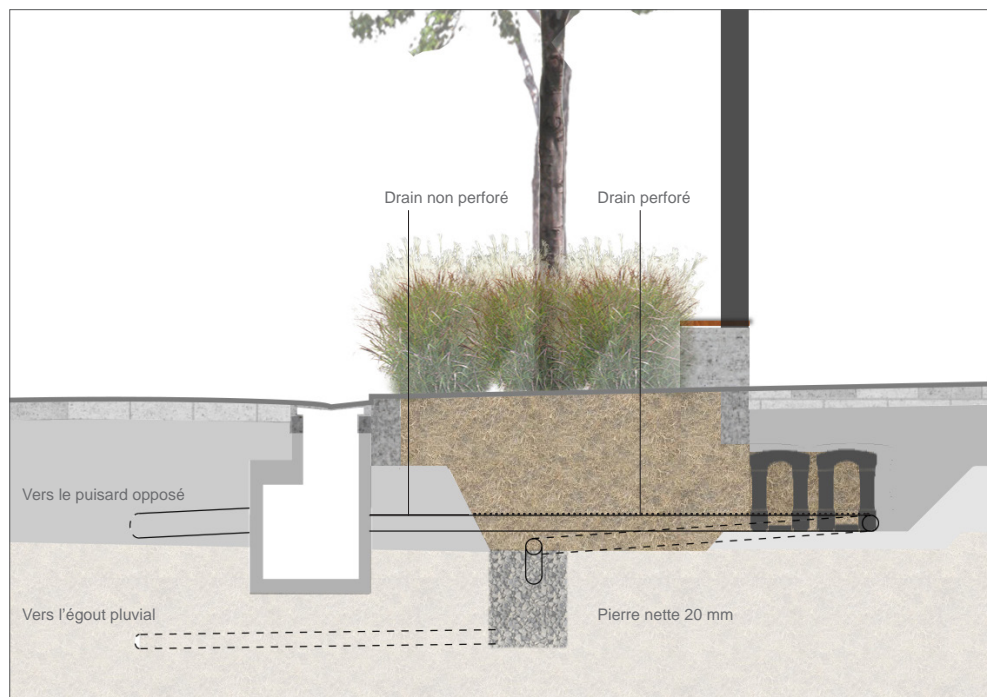
Déviation de l'eau dans les fosses de plantation
