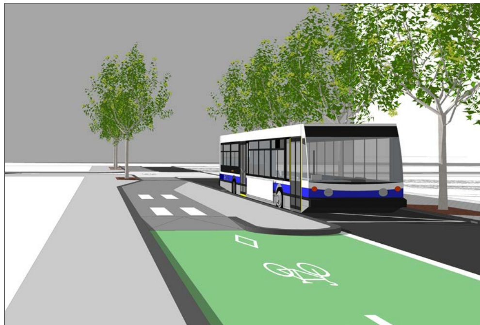
Quai d'autobus arrête aux intersections avec feux de signalisation
