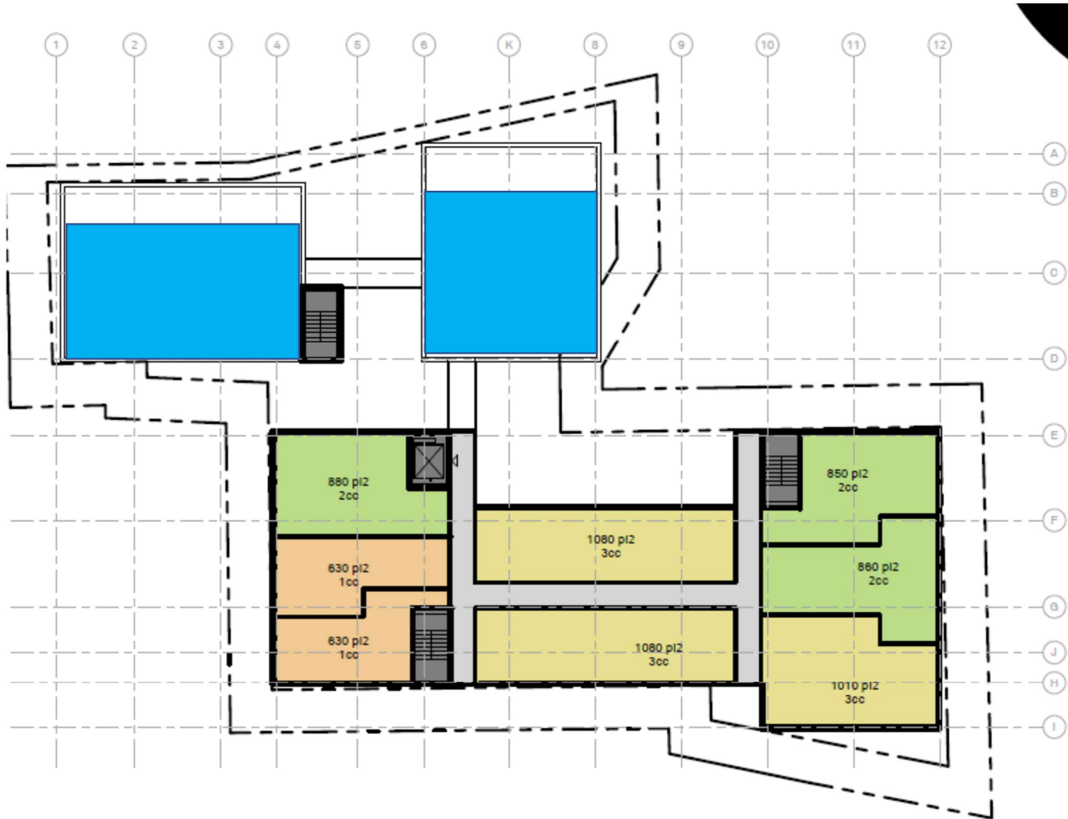
Figure 4) Proposition d'ajout (en bleu) d'unités au 4 e étage du projet, tout en conservant 3 étages en façade avec Notre-Dame
