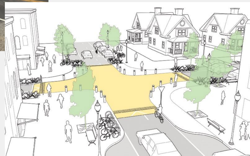
Image: Figure 8: Intersection surélevée, NACTO
