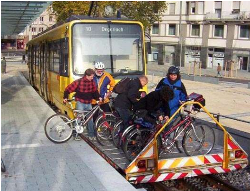
Figure 11 - Plateforme à vélo annexée au tramway de Stuttgart, en Allemagne. Source : Idea Connection
