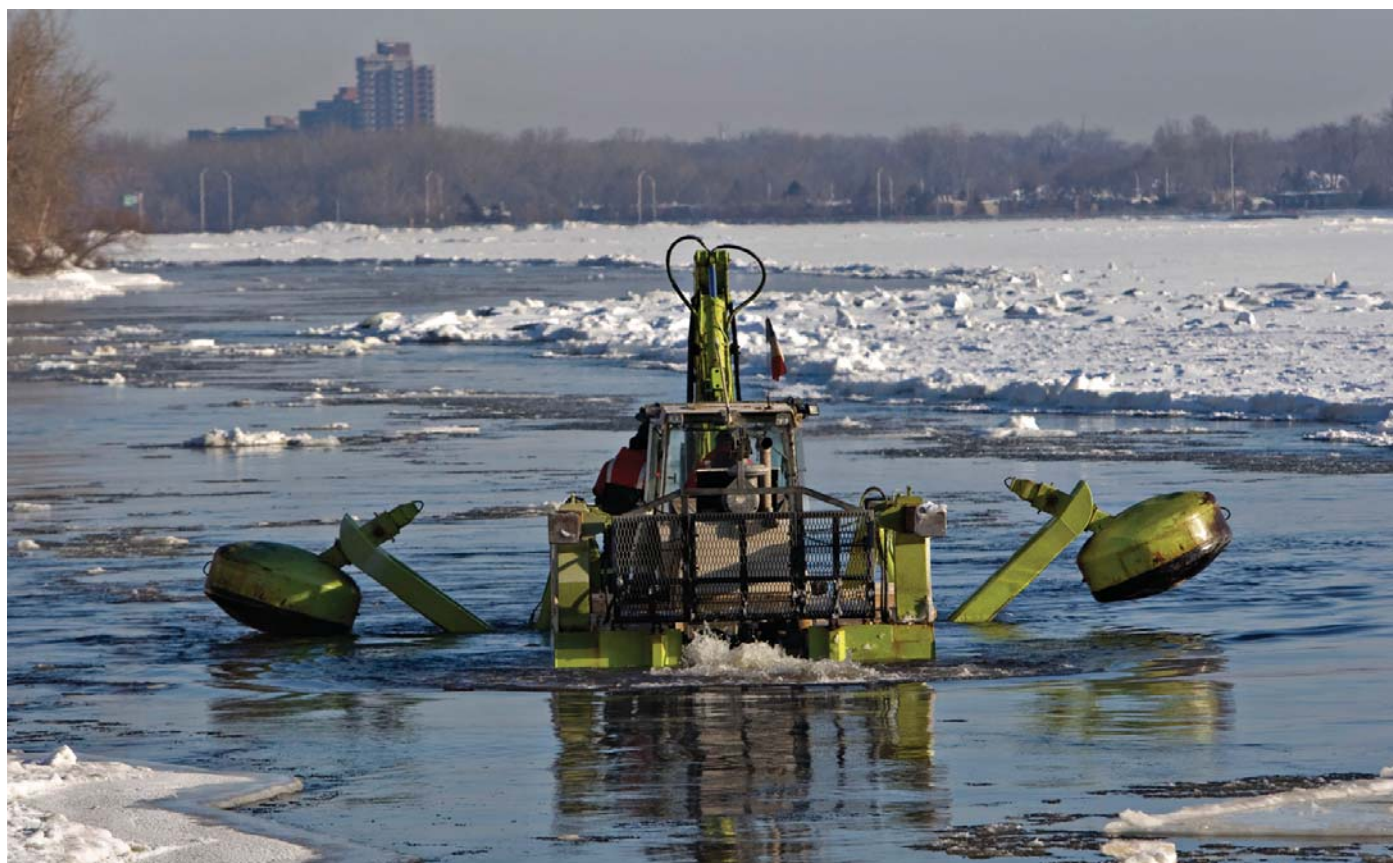
La rétrocaveuse amphibie « grenouille » est à l'œuvre dans la rivière des Prairies. (27.01.2009) Crédit : © Ivanoh Demers, La Presse
