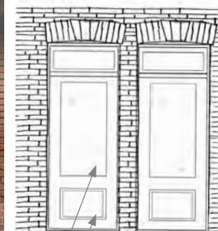
Porte simple imposte et vitrage Caisson de bois
