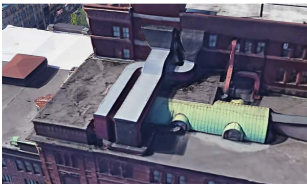
La voûte est chevauchée par des gaines de ventilation (en jaune) et est arrimée avec la construction probable de 1905 (en rouge).
