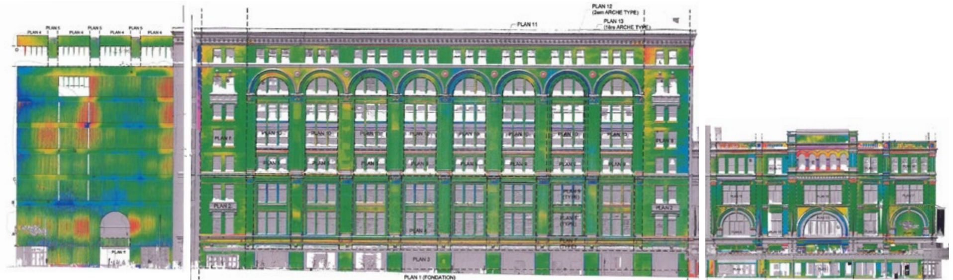
Façade Union - Collage des élévations de l'analyse de déformation effectuée par iScan.
