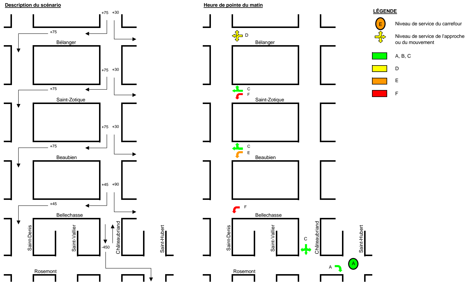
Figure 3.6 Schéma descriptif du scénario 4b et impact sur les niveaux de service aux carrefours
