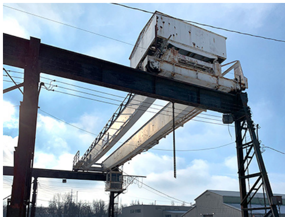
▲ Figure 107. Le pont roulant dont la capacité de levage est de 30 tonnes.
