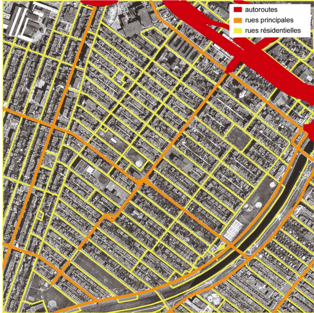
Figure 61: Fragment typique de la forme urbaine. (Partie des quartiers Ville Émard et Verdun.) Trame de rues avec croisements multiples; rues secondaires et rues principales.
